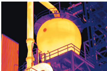
石油化学反応炉の断熱材検査
