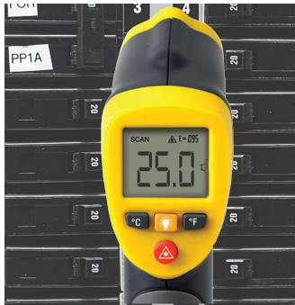
放射温度計は単一スポットの温度を計測する
